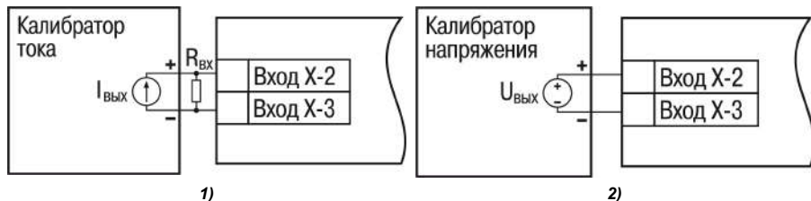
Рисунок 8.6 – Подключение калибратора: 1) постоянного тока, 2) постоянного напряжения
